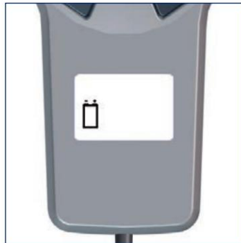
La batería se está cargando.
